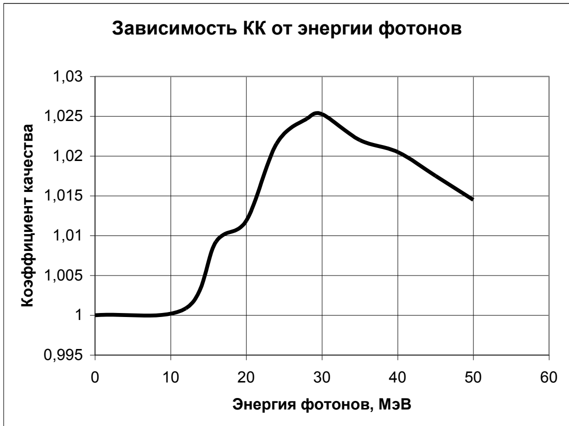
Рис.4. Энергетическая зависимость коэффициента КК пучка тормозных фотонов.
