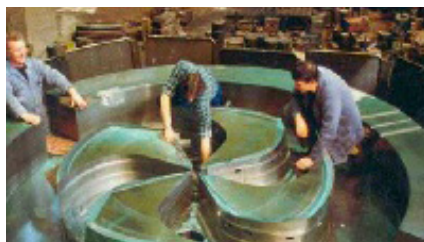
Рис. 3.2.6 Протонный циклотрон С-235 компании IBA. Слева направо: общий вид ускорителя, ускоритель в процессе сборки, спиральные полюса магнита
