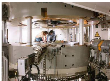
Рис. 3.2.6 Протонный циклотрон С-235 компании IBA. Слева направо: общий вид ускорителя, ускоритель в процессе сборки, спиральные полюса магнита
