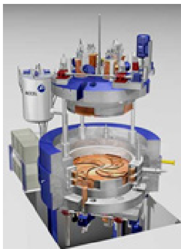
Рис. 3.2.9 Вид на ускоритель Varian Medical Systems с поднятой крышкой (слева), ускоритель в процессе монтажа (справа)
