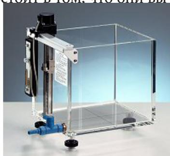
**Рис. 8. Водный фантом для проведения дозиметрических измерений**
