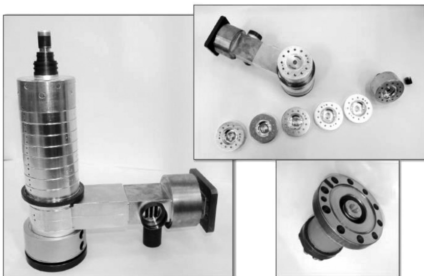
Рис. 4.4. Ускоряющая секция на энергию 4 МэВ и клистрон на частоту 5712 МГц производства НПП «Торий»
