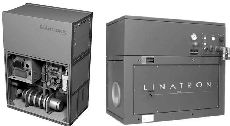
Рис. 2.12. Внешний вид ускорителей Скантроник УЭЛР-6-1-Д-4-01 — слева ; Varian Linatron Mi6 — справа
