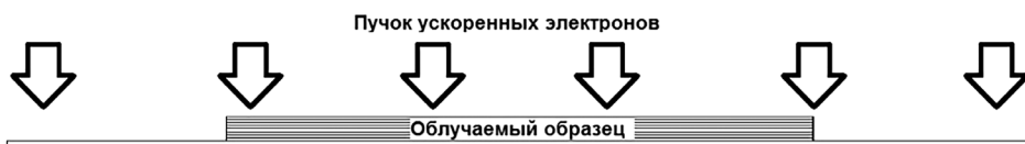
Рис. 3.8. Схема облучения объекта пучком ускоренных электронов
